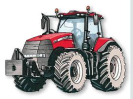
Breite: 270 cm: Länge: 708 cm (mit Frontkraftheber); Höhe: 344 cm
