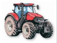
Breite: 250 cm: Länge: 494 cm (mit Frontkraftheber); Höhe: 303 cm (GPS)
