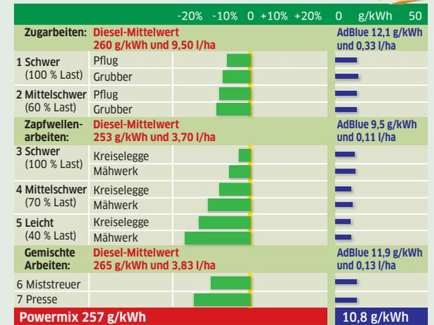
Messwerte vom Rollenprüfstand: Unten links steht der Powermix-Wert in g/kWh als Mittel aller 7 gemessenen Zyklen. Die Mittelwerte bei „Zugarbeiten“, „Zapfwellenarbeiten“ und „Gemischte Arbeiten“ sind mit dem Dieselverbrauch in Gramm pro Kilowatt und Stunde und in Litern pro Hektar in roter Schrift angegeben.
