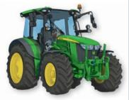
Breite: 225 cm; Länge: 458 cm (mit Frontkraftheber); Höhe: 277 cm
