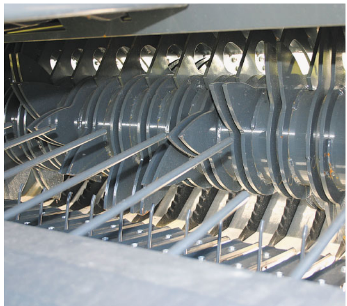
Bild 4: Der zweireihige Schneid- und Förderrotor ist elektro-hydraulisch vom Schleppersitz reversierbar. Die Messer besitzen eine Einzelfremdkörpersicherung und sind zum Wechsel sehr gut vom hinteren Bereich der Maschine erreichbar.
