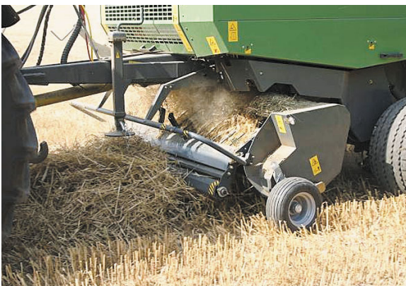
Bild 3: Die Pick-Up nimmt auch kleines Material sauber auf und ist von der Kabine aus gut einsehbar. Das Aufnahmevermögen von Pick-Up und Schneidrotor ist hoch.
