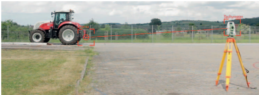
Bild 2: Messaufbau des optischen Referenzsystems
