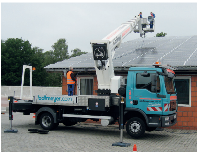
Bild 3: Das Solarreinigungsunternehmen beim Reinigen mit dem Hubsteiger innerhalb der Prüfung
