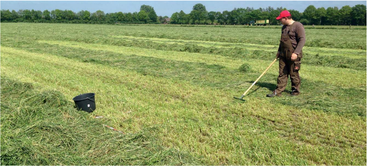
Bild 8: Erfassung der Rechverluste durch Aufrechen und Einwaage der Resthalme
