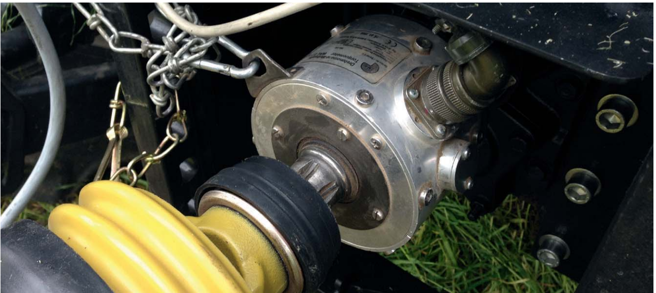
Bild 9 und 10: Kistler Correvit L400 und Walterscheid 2,5 kNm Messnabe an der Heckzapfwelle
