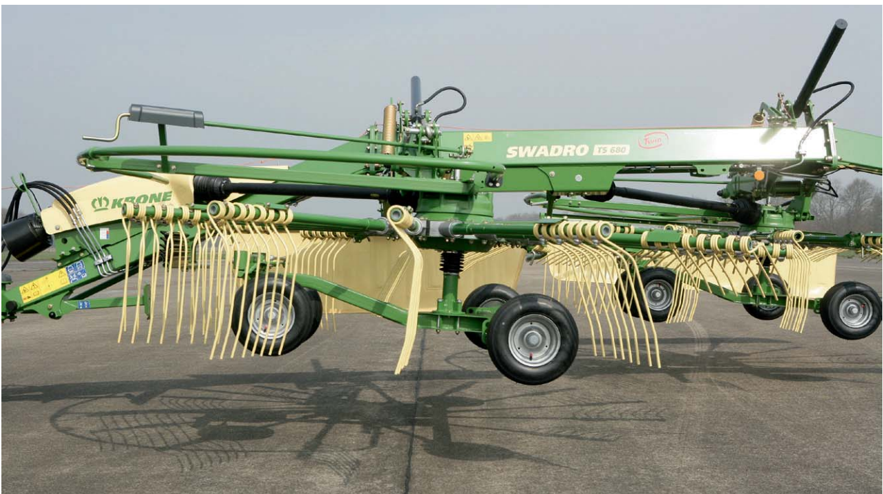
Bild 14 und 15: Anbau des KRONE Swadro TS 680 Twin an den Schlepper, ausgehobene Kreiseleinheit (KRONE Produktfotos)
