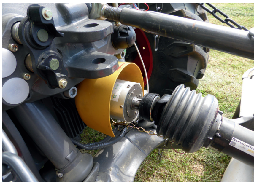
Bild 5: Walterscheid 2,5 kNm Messnabe an der Frontzapfwelle
