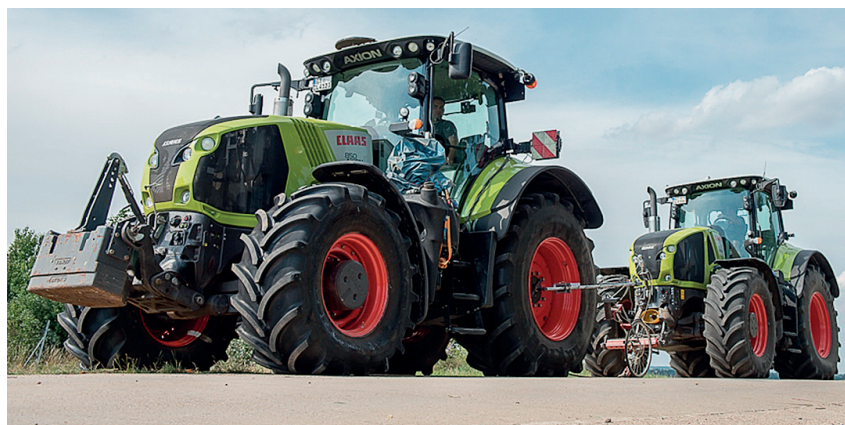
Bild 2: Zugschlepper mit zu testenden Reifen und Bremschlepper
