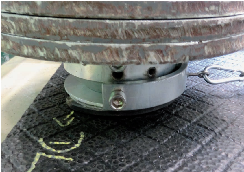
Bild 2: Rutschfestigkeitsmessung nass, mit Barhuf
