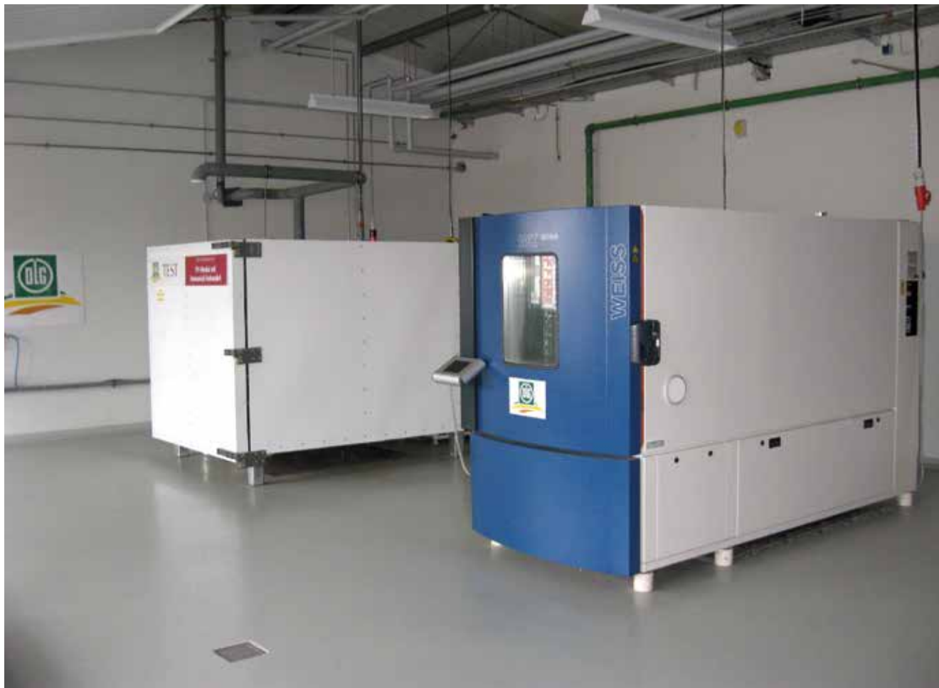
Bild 2: DLG-Prüflabor – Zwei Ammoniakkammern
