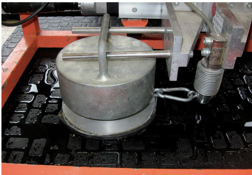
*Bild 3: Rutschfestigkeitsmessung nass, mit Hufeisen*
