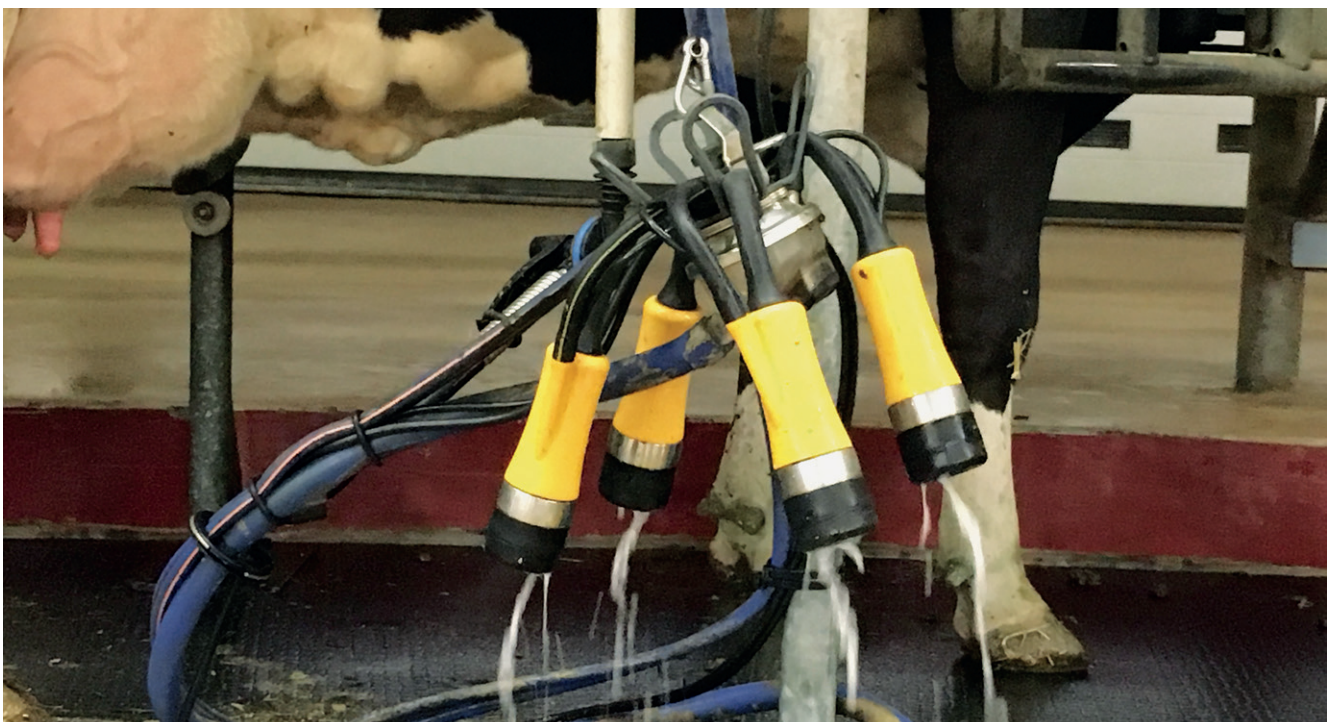
Bild 6: ADF 5 -Melkzeug während der Zwischenreinigung und -desinfektion
