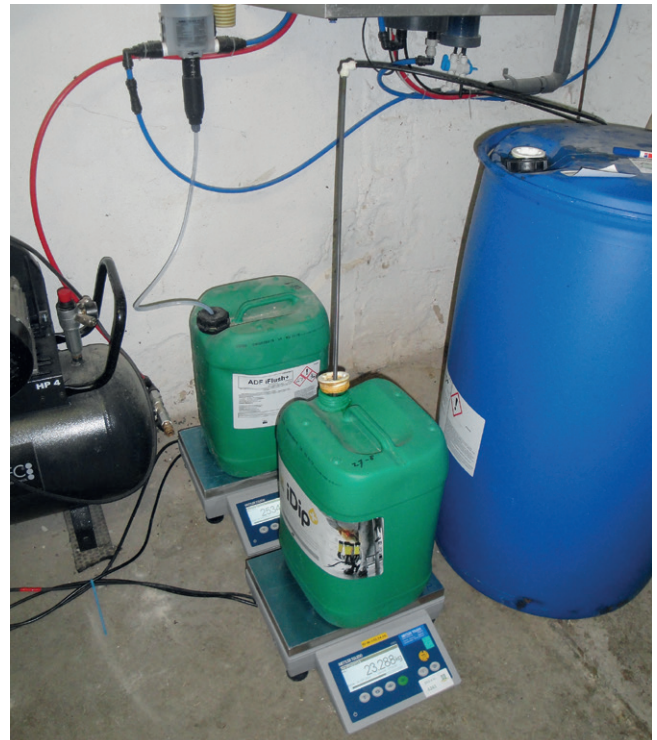
Bild 3: Gewichts- und Differenzmessung der eingesetzten Betriebsmittel
