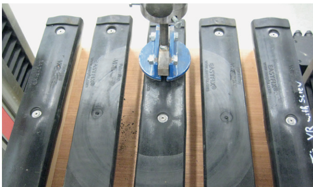
Bild 6: Prüfmuster nach der Dauertrittbelastung
