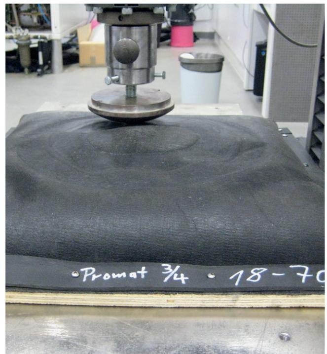
Bild 4: Messung der Verformbarkeit
