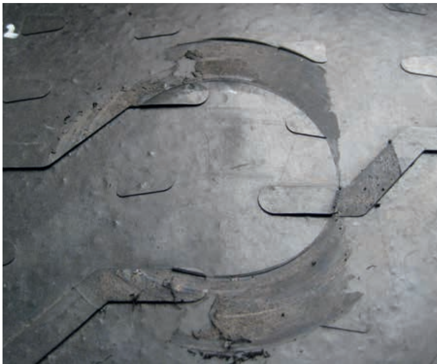
Bild 6: Testmuster nach dem Abriebtest
