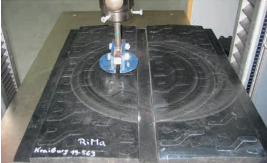
Bild 2: Messung der Verformbarkeit mit Kuhfuß
