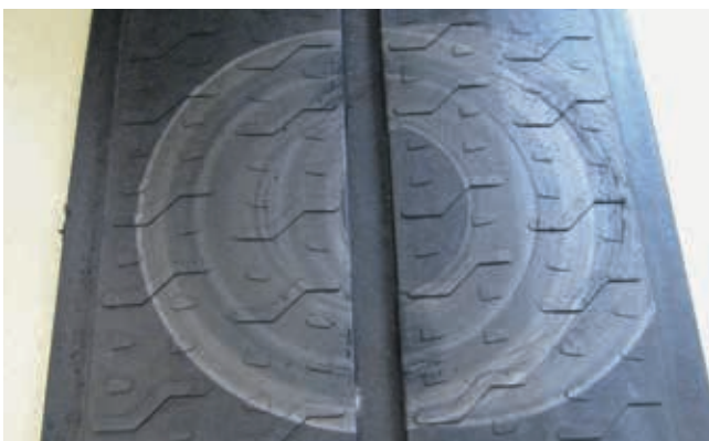
Bild 4: Prüfmuster nach der Dauertrittbelastung
