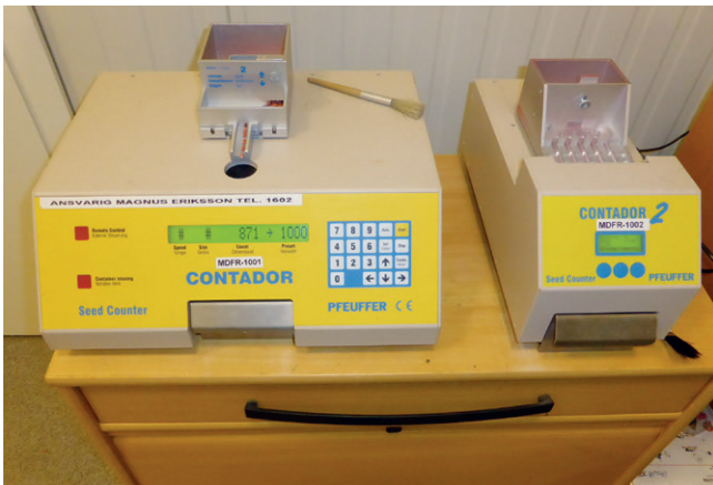
Bild 4: Körnerzählgeräte zur Ermittlung der Anzahl an ausgegebenen Körnern während der Versuchszeit
