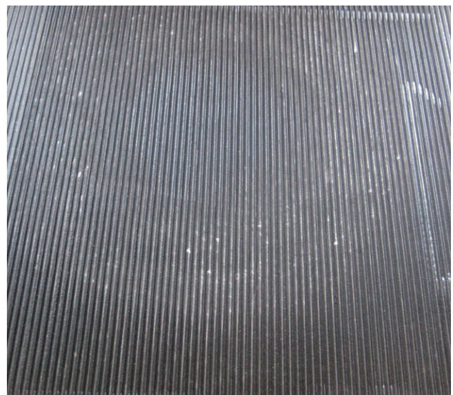
Bild 5: Unterseite Bodenbelag – nach der Dauertrittbelastung
