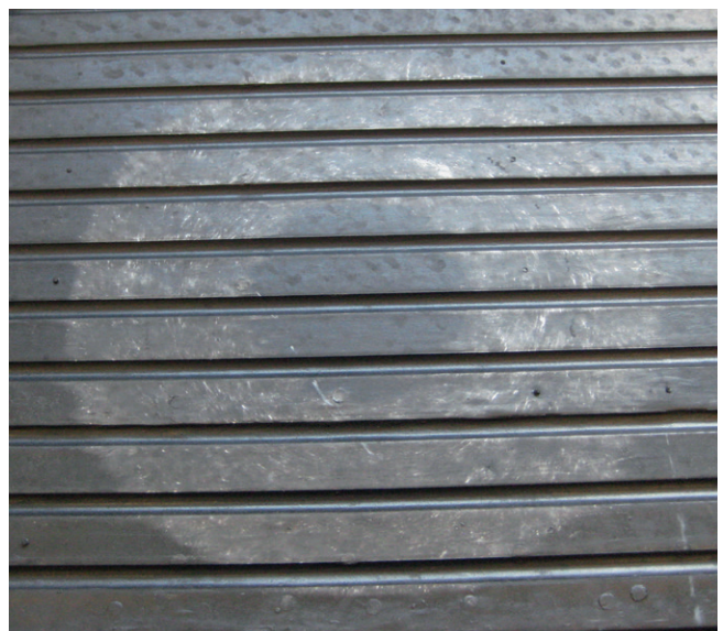
Bild 5: Unterseite Bodenbelag – nach der Dauertrittbelastung
