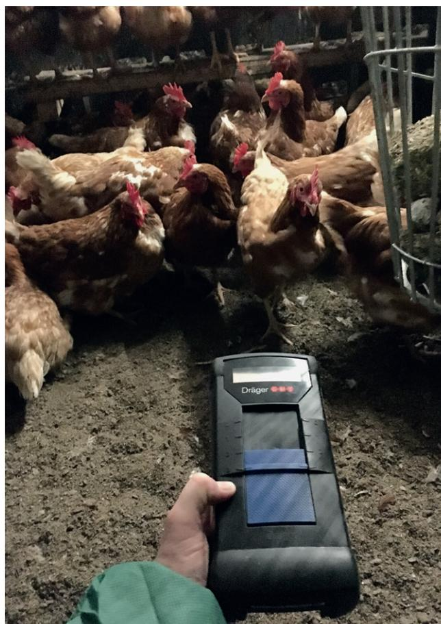
*Bild 5: Orientierende Ammoniakmessung mit dem Dräger Gasmessgerät*
