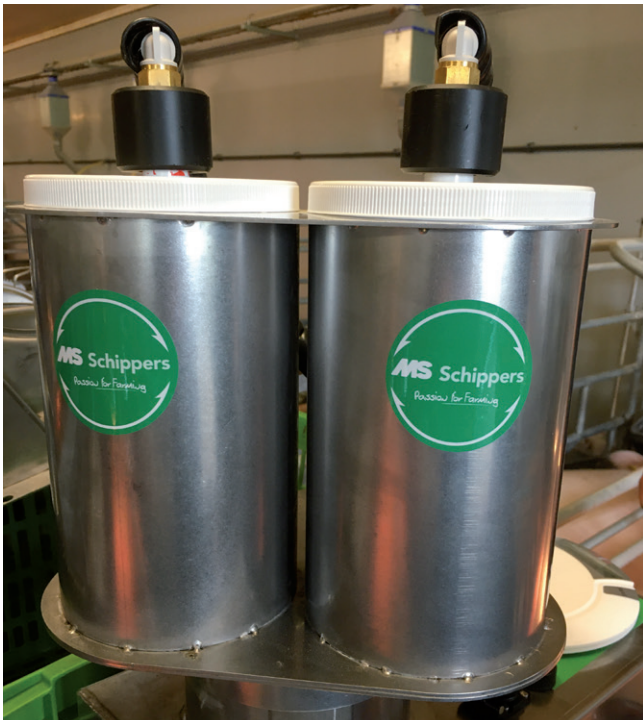
Bild 8: Parallele Aktivkohlefilter am Pigsleeper – Reste der roten Kappenversiegelung links zu sehen
