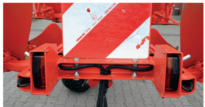
Bild 7: Beleuchtung eingeklappt für Feldarbeit
