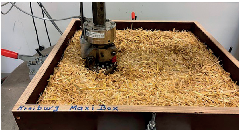
Bild 3: Dauertrittbelastung, Prüfmuster mit Einstreu
