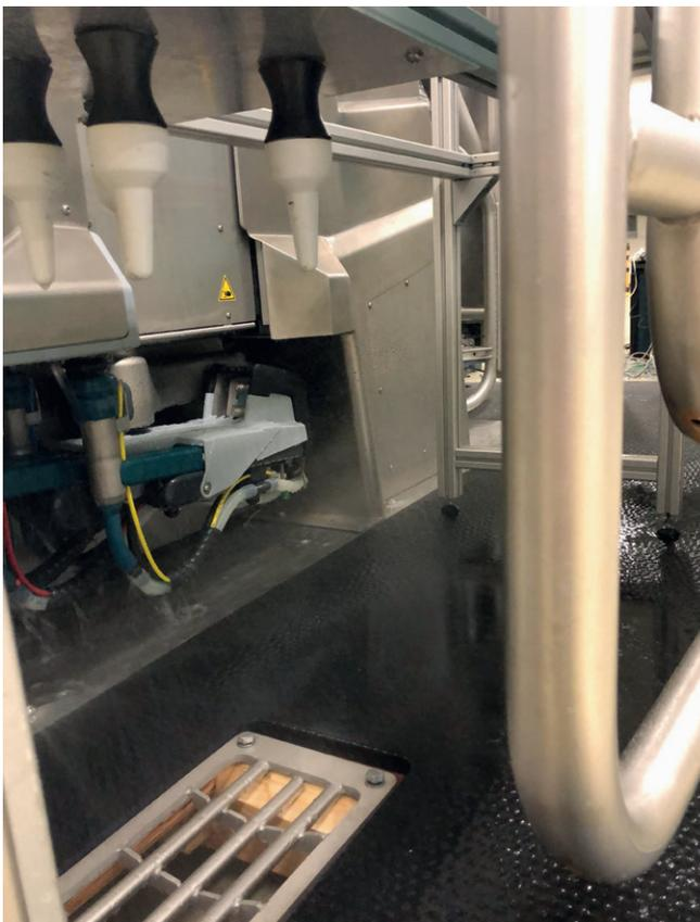
Bild 6: Melkzeugaußenreinigung (Bild: DLG)
