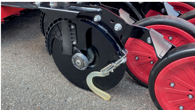
Bild 2: DuoDisc-Doppelscheibenschar mit beweglichem Innenabstreifer und Tiefenführungsrolle
