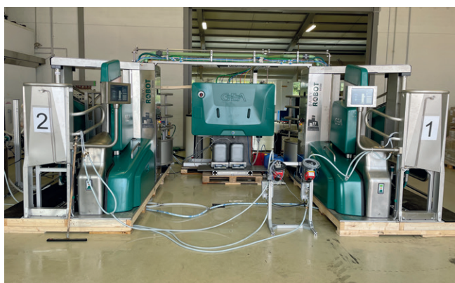
Bild 2: Testaufbau des GEA DairyRobot R9500 Multiboxsystems mit 2 Boxen
