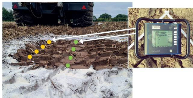
Bild 8: Einstichstellen Penetrometer (gelb Schulter, grün Mitte)
