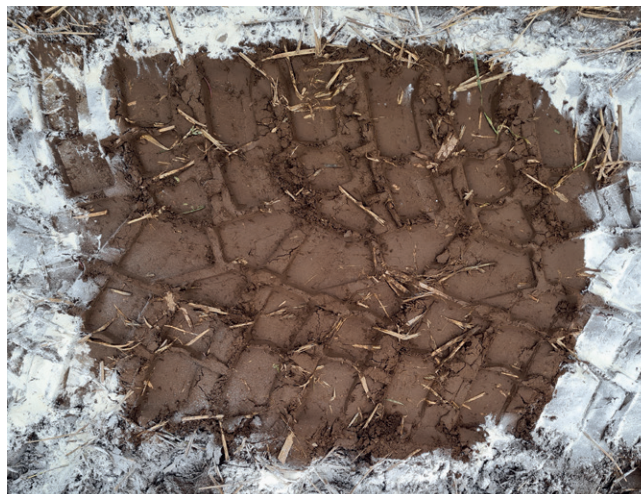
Bild 4: Umstäubte Radaufstandsfläche bei IP 1,0 bar (Vredestein Flotation Optimall VF)
