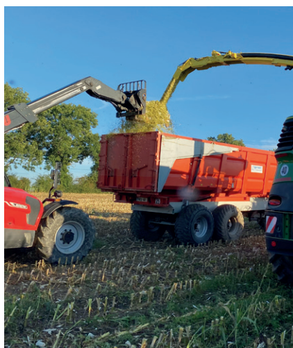
Bild 5: Entnahme von Silomais aus dem Gutstrom zur Bestimmung der technischen Häckselqualität
