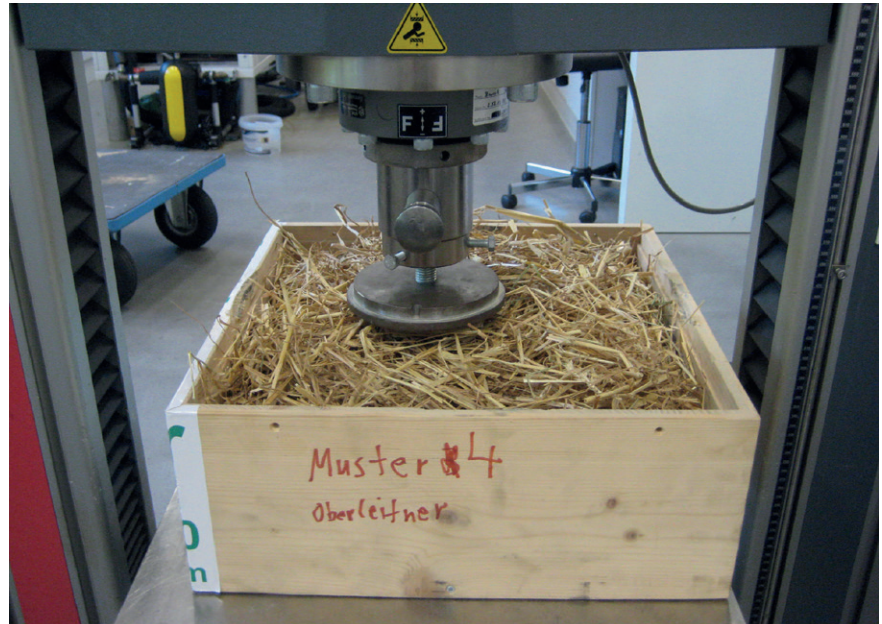
Bild 4: Messung der Verformbarkeit im Neuzustand
