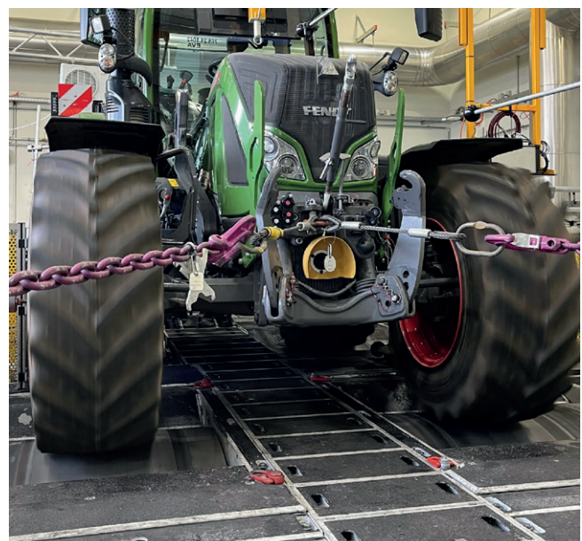
Bild 3: Traktor auf dem DLG Rollenprüfstand
