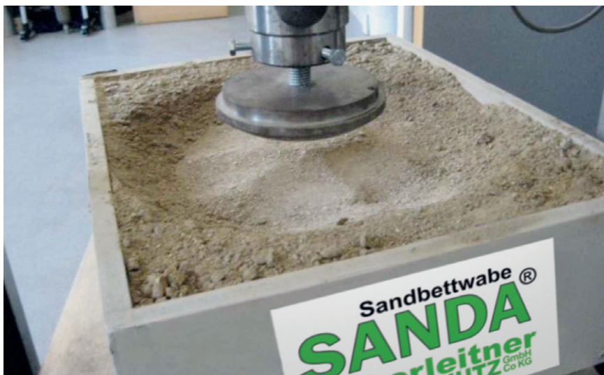
Bild 7: Messung der Verformbarkeit nach der Dauertrittbelastung
