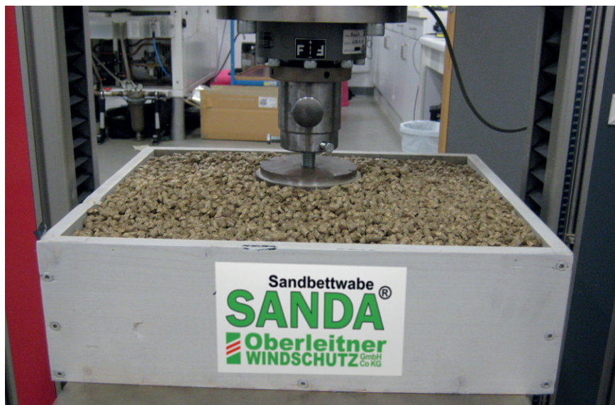
Bild 4: Messung der Verformbarkeit mit Strohpellet-Einstreu im Neuzustand
