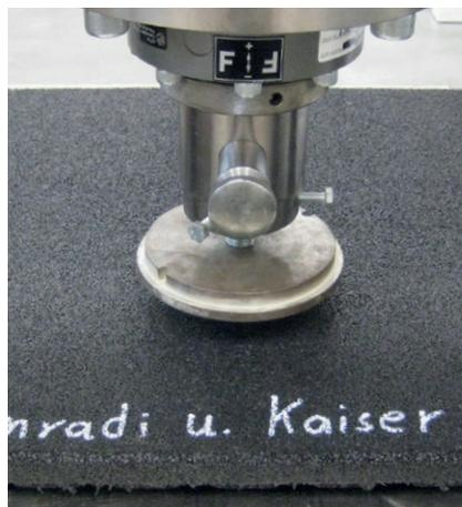
Bild 4: Messung der Verformbarkeit mit Kalotte
