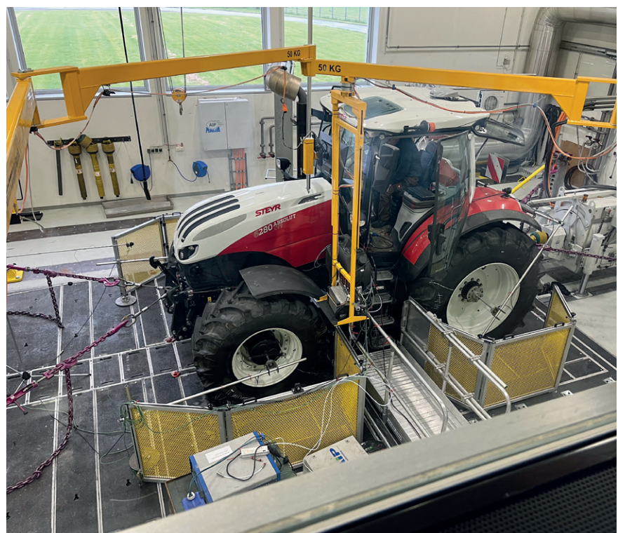
Bild 6: Transportfahrt auf dem DLG-Rollenprüfstand
