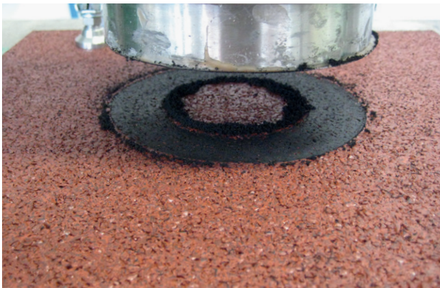
Bild 2: Testmuster nach dem Abriebtest
