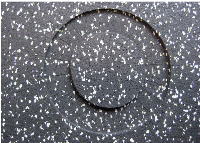
Bild 2: Testmuster nach dem Abriebtest
