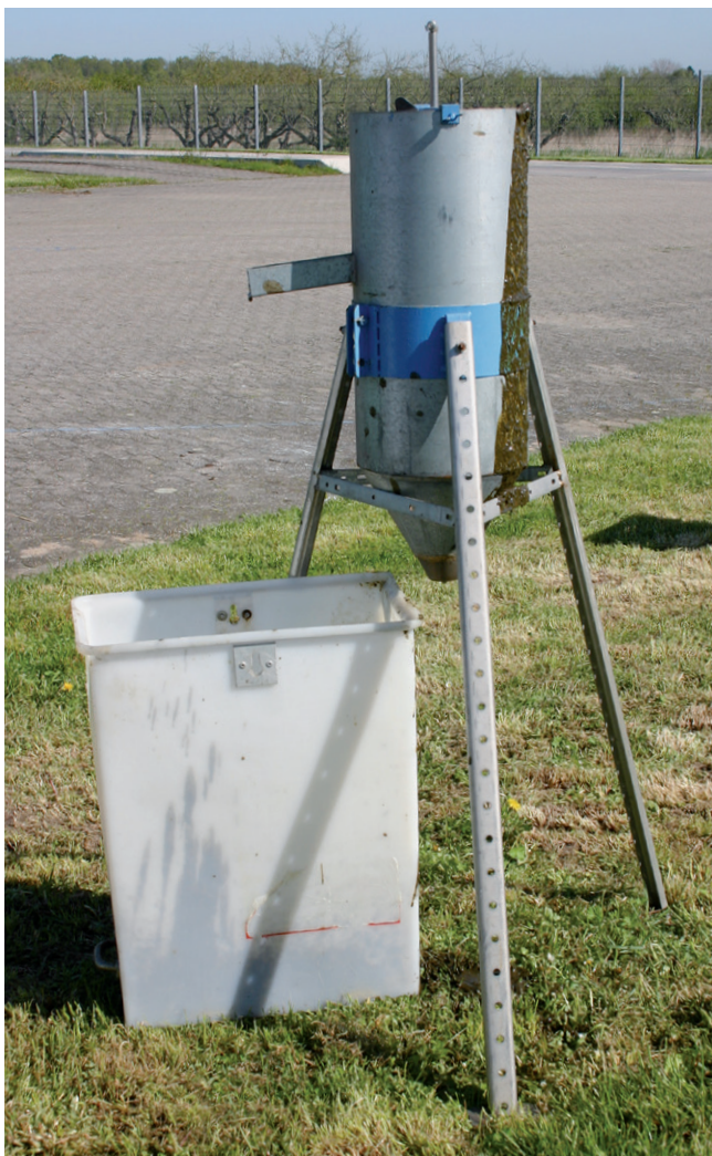
Bild 5: Fluidmeter zur Bestimmung der Fließfähigkeit von Flüssigmist
