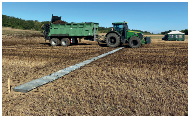
Bild 2: Mobiler Prüfstand zur Ermittlung der Querverteilung
