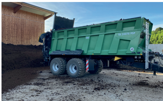
Bild 3: BRANTNER TA 24078 POWER-SPREAD pro während der Ermittlung der Längsverteilung
