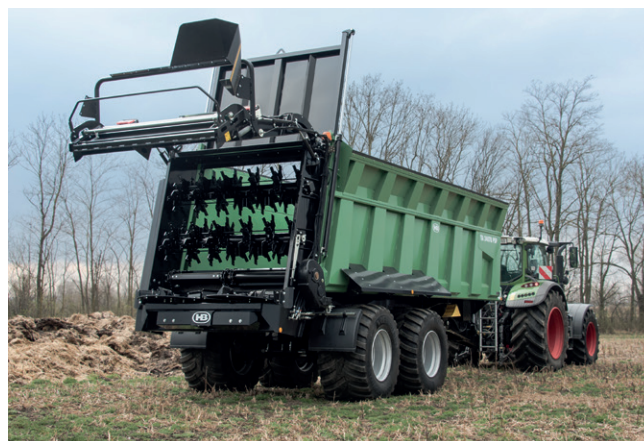
Bild 6: Universalstreuwerk am BRANTNER TA 24078 POWER-SPREAD pro
