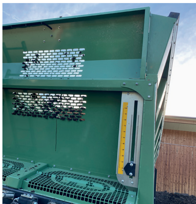
Bild 5: Anzeige an der Vorderwand des Streuers für die Öffnungshöhe des Stauschiebers
