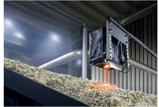
Bild 2: KWS BEETROMETER® – stationär in der Zuckerfabrik
