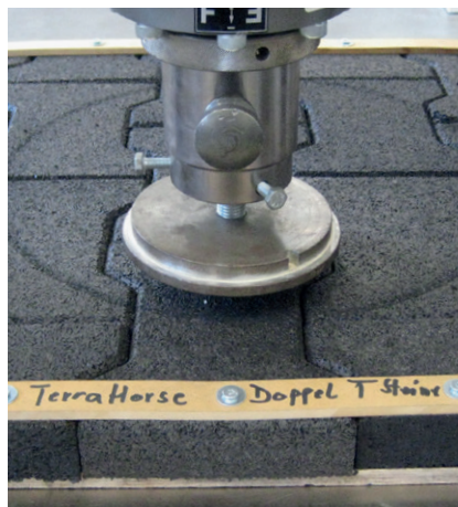
Bild 4: Messung der Verformbarkeit mit Kalotte
