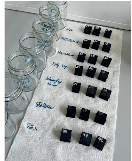
Bild 4: Prüfmuster nach Säure- beständigkeitstest
