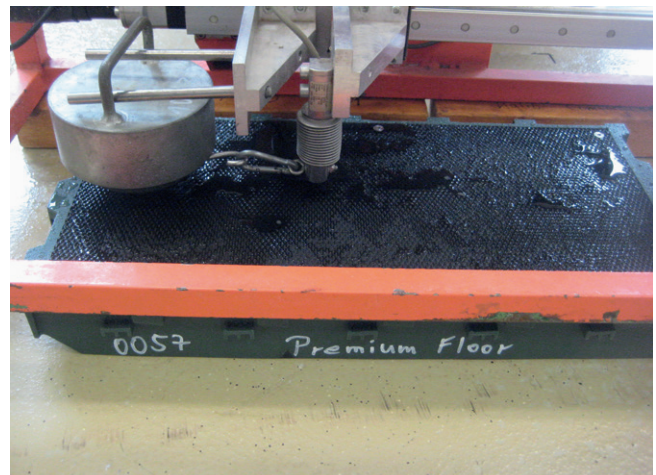
Bild 3: Messung der Rutschfestigkeit
