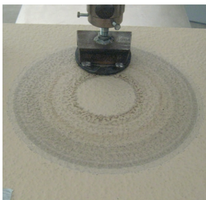
Bild 3: Messung der Verformbarkeit nach Dauertrittbelastung
