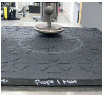
Bild 3: Messung der Verformbarkeit nach Dauertrittbelastung
