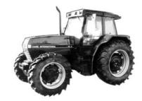
ZUGLEISTUNG: max. 65,3 kW bei 6,9 km/h und Motordrehzahl 2150 min<sup>-1</sup>, dabei 292 g/kWh, Zugleistung bei Nenndrehzahl 64,9 kW bei 7,1 km/h, dabei 293 g/kWh
