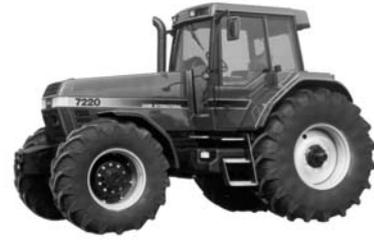
**ZUGLEISTUNG:** max. Leistung 109,0 kW bei 9,9 km/h und Motordrehzahl 2000 min<sup>-1</sup>, dabei 282 g/kWh, bei Nenn Drehzahl 102,9 kW bei 10,9 km/h, dabei 307 g/kWh
