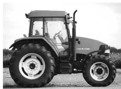
ZUGLEISTUNG: max. Leistung 43,9 kW bei 9,1 km/h und Motordrehzahl 2100 min<sup>-1</sup>, dabei 328 g/kWh, bei Nenndrehzahl 41,6 kW bei 9,5 km/h, dabei 357 g/kWh.
