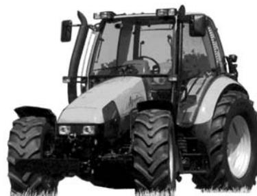
**ZUGLEISTUNG:** max. Leistung 58,9 kW bei 7,9 km/h und Motordrehzahl 2100 min<sup>-1</sup>, dabei 290 g/kWh, bei Nenn Drehzahl 52,6 kW bei 8,8 km/h, dabei 315 g/kWh
