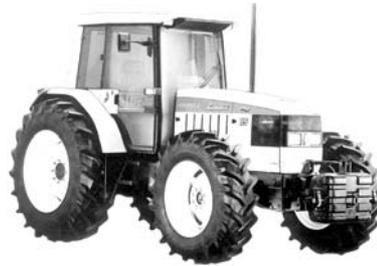
**ZUGLEISTUNG:** bei Nennndrehzahl 66,3 kW bei 10,33 km/h, dabei 295 g/kWh
