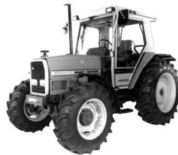
ZUGLEISTUNG: max. 43,2 kW bei 11,2 km/h und Motordrehzahl 2134 min<sup>-1</sup>, dabei 324 g/kWh, bei Nenndrehzahl nicht gemessen
