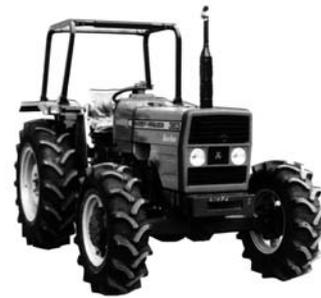
**ZUGLEISTUNG:** bei Nenn Drehzahl 33,5 kW bei 6,3 km/h, dabei 305 g/kWh
